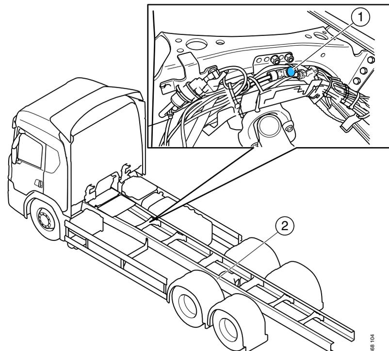
*Emplacement des connecteurs d'air comprimé pour carrossiers.*
