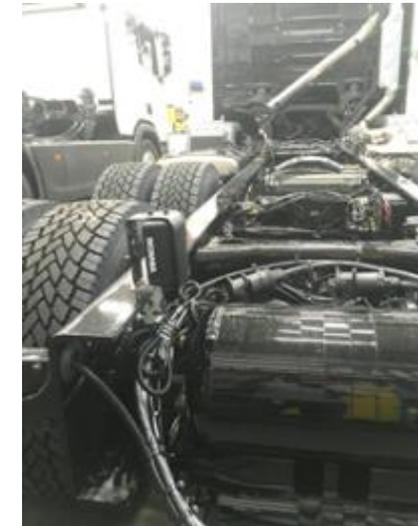
**Achtung:** Die Rückfahrkamera ist vorläufig angebaut. Die Beladekamera ist vorbereitet und wird im Fahrerhaus mitgeliefert.
