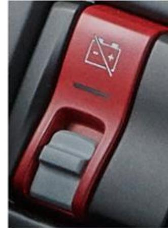
**Alt**, Batterieauptschalter mit Kontrollleuchte
