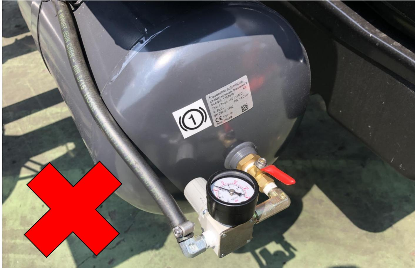
不可於氣瓶端接氣壓錶或擷取氣管及任何氣壓源設備
