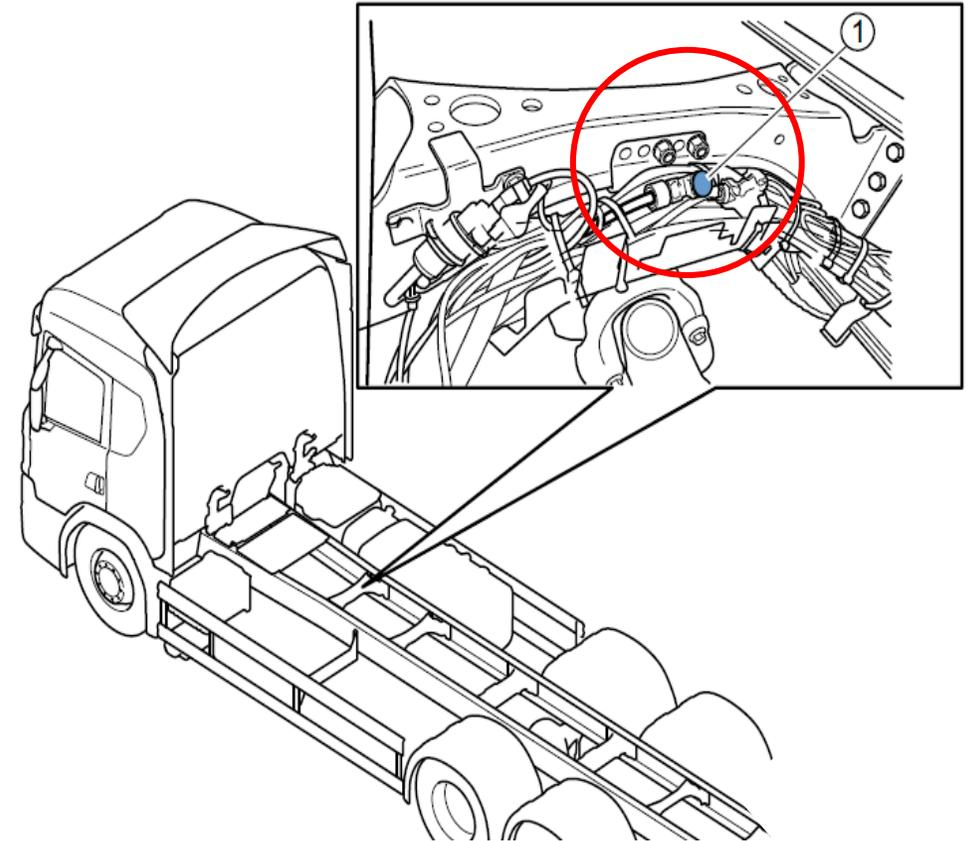
車體廠如果需安裝額外氣壓來源，原廠已經準備好壓縮空氣接頭（1）位於第三橫樑上。從壓縮空氣接頭拔下塞子後，裝入快速接頭。將管徑 12 mm 的壓縮空氣管與快速接頭連接起來後即可使用。
